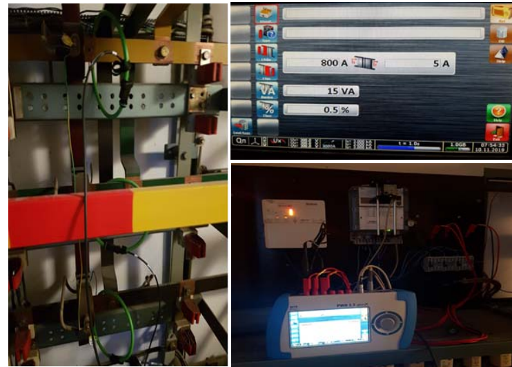
Slika 3. Provedba kontrole mjernog mjesta u poluizravnom spoju
